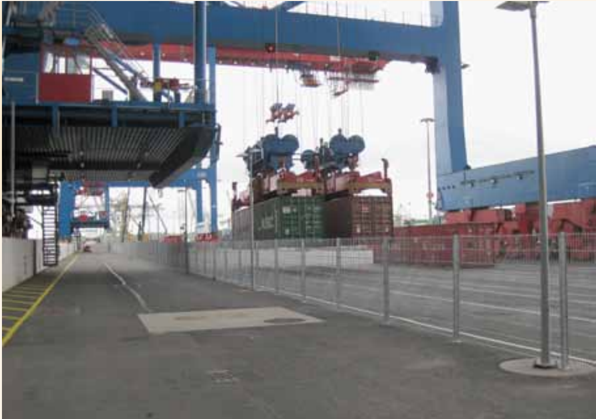
Ein Tandem-Containerpärchen wird im Brückenportal abgesetzt.
