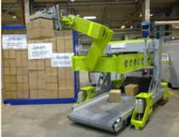
Entladeroboter mit Variante Passivförderer
