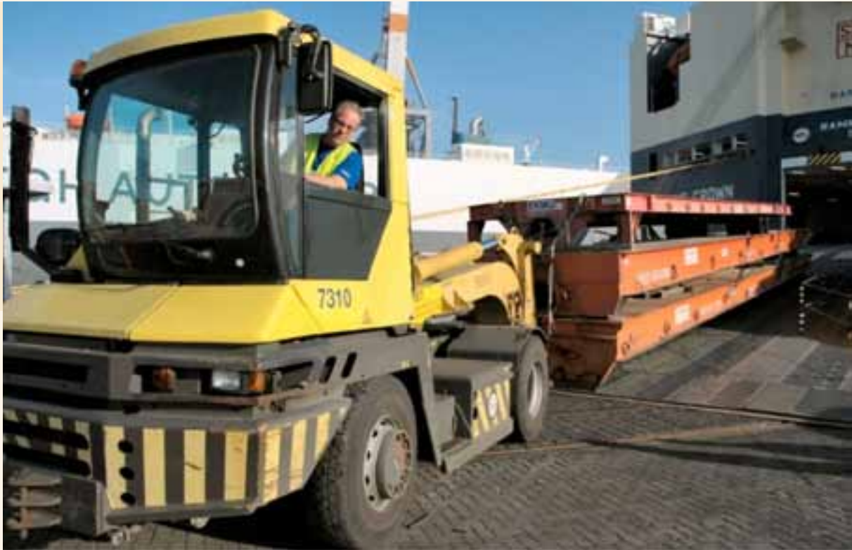
Zugmaschine mit gestapelten Rolltrailern
